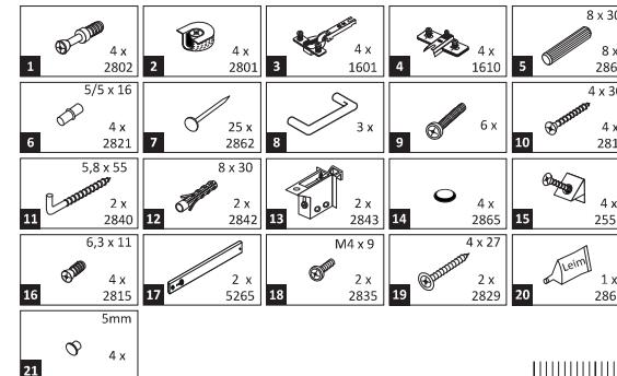
Das beigelegte Wandbefestigungsmaterial (Dübel und Schrauben) eignet sich nur für festes Mauerwerk (z.B.: Beton- oder Ziegelwände). Für andere Wandaufbauten sind eventuell Spezialdübel und andere Schrauben notwendig. Ziehen Sie gegebenenfalls eine Fachkraft zu Rate.
