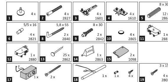
Das beigelegte Wandbefestigungsmaterial (Dübel und Schrauben) eignet sich nur für festes Mauerwerk (z.B., Beton- oder Ziegelwände). Für andere Wandaufbauten sind eventuell Spezialdübel und andere Schrauben notwendig. Zeigen Sie gegebenenfalls eine Fachkraft zu Rate.
