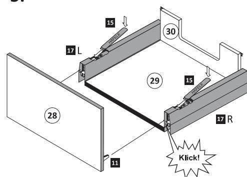
Führen Sie die Schubkastenblende 28 mit dem Beschlag 11 wie abgebildet in die Zargen 17 ein. Der Beschlag 11 rastet ein !
